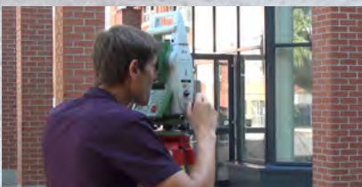
Gebäudeaufmaß mit Totalstation Quelle: Keßler Ingenieur Consult
